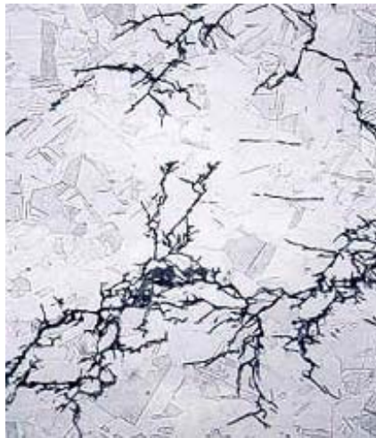
Figura 4.10.- Fisuras creadas bajo la condición de corrosión bajo esfuerzo.
