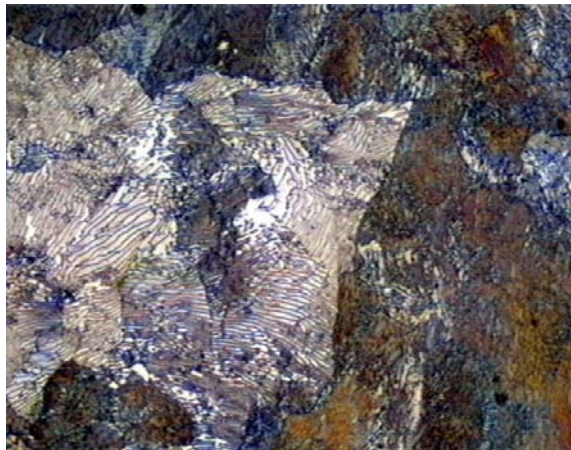
Figura 2.5.- Perlita en un acero eutectoide
